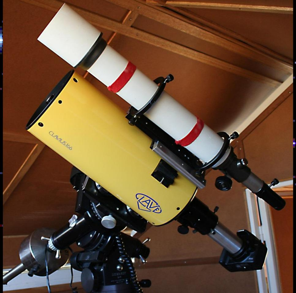
**Télescope Clavius 166 – diamètre 160 mm – focale 1072mm – sur monture motorisée**
