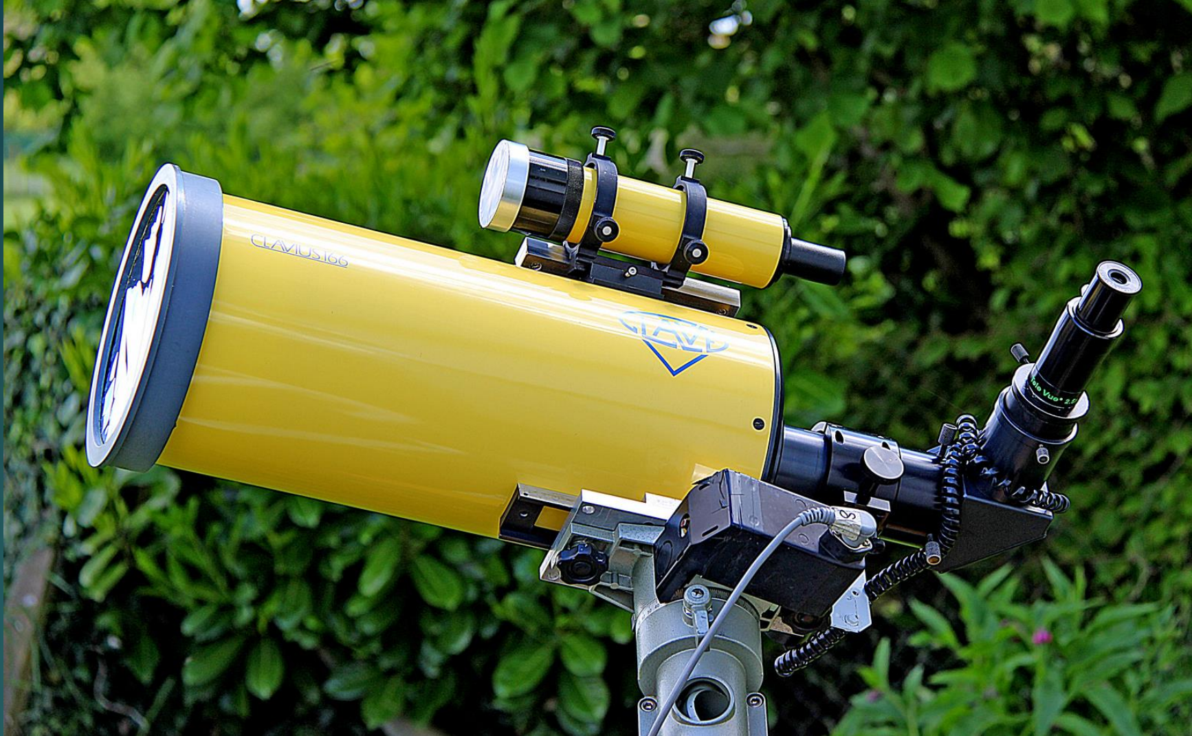
Télescope Clavius 166 – Filtre solaire Astrosolar Baader Appareil photo Canon 600D – Mise au point Live View
